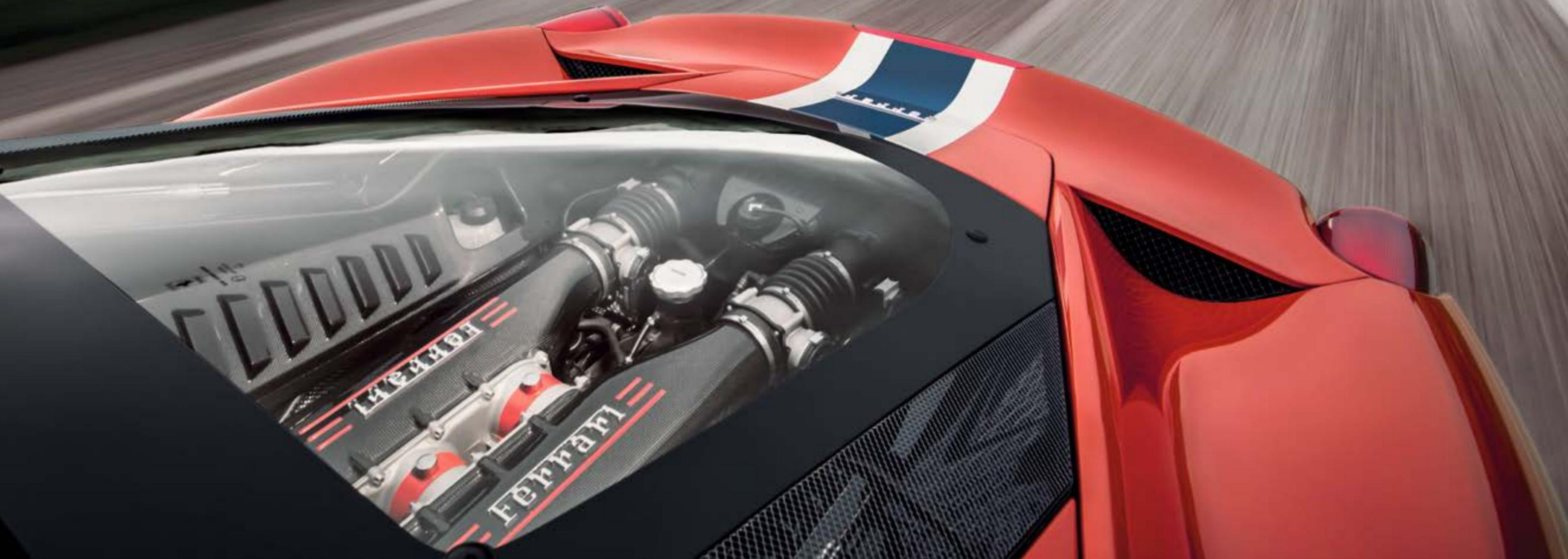
**I**l motore V8 centrale-posteriore a iniezione diretta da 4.497 cm<sup>3</sup> della 458 Speciale è l'otto cilindri aspirato Ferrari più potente di sempre, capace di erogare 605 CV a 9000 giri/min e 540 Nm di coppia massima a 6000 giri/min. La potenza specifica record di 135 CV/l è la più alta raggiunta da un propulsore atmosferico per uso stradale. Evidentemente, un'auto Speciale non poteva che avere un propulsore altrettanto evoluto.
