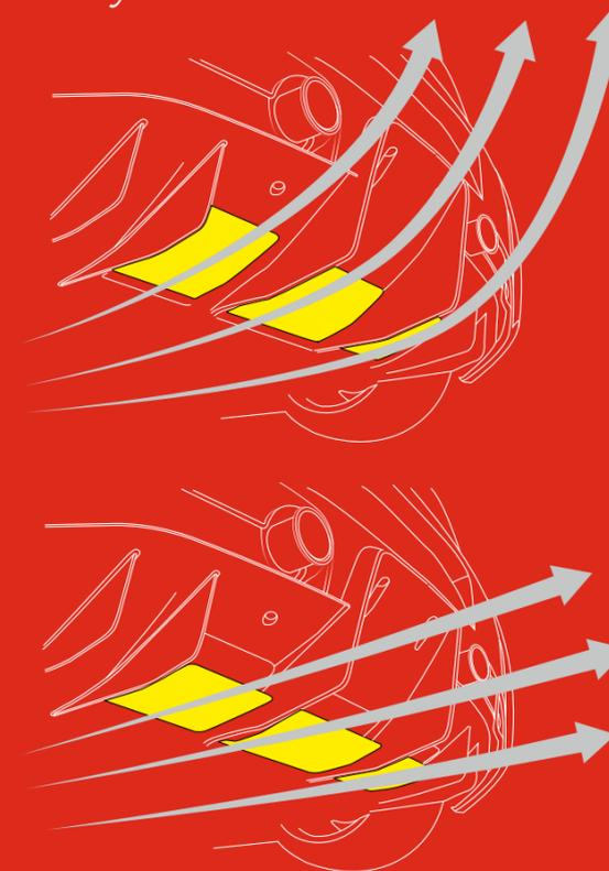
*I flap posteriori mobili si alzano e abbassano a seconda delle necessità, per fornire maggior carico aerodinamico o minor resistenza. Possono essere abbattuti e mandare in stallo il diffusore.*
